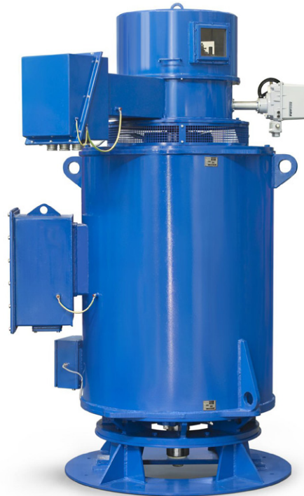
SLIP-RING MOTOR TYPE AV 630 LK4 1420 kW – 11000 V – 50 Hz – 1500 rpm – 4P – V1 – IP23 FOR WATER PUMP
